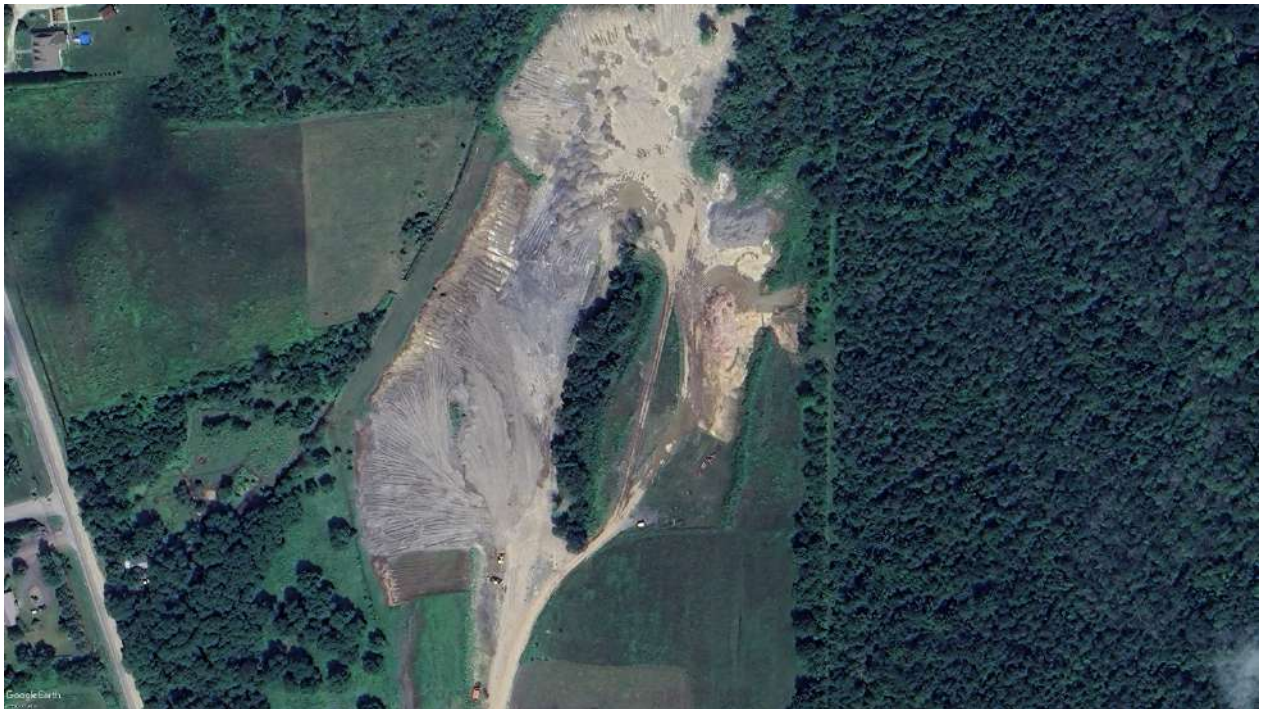
Figure 3. Le terrain boisé est transformé en site de dépôt sauvage. On y observe plusieurs indicateurs typiques de dépôts sauvages, soit des signes clairs de déforestation, la présence de machinerie lourde, des amas de sols et leur étalement, ainsi que l'absence de documentation publiquement accessible permettant de justifier ces opérations dans le respect du cadre réglementaire. Source : Google. (2026, 1 avril). [Image satellite]. Google Earth Pro. https://www.google.com/earth/
